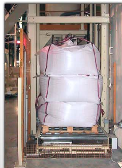
Sistema di sovrapposizione di tre sacchi su singola paletta.
